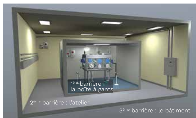
Barrières de confinement statique
