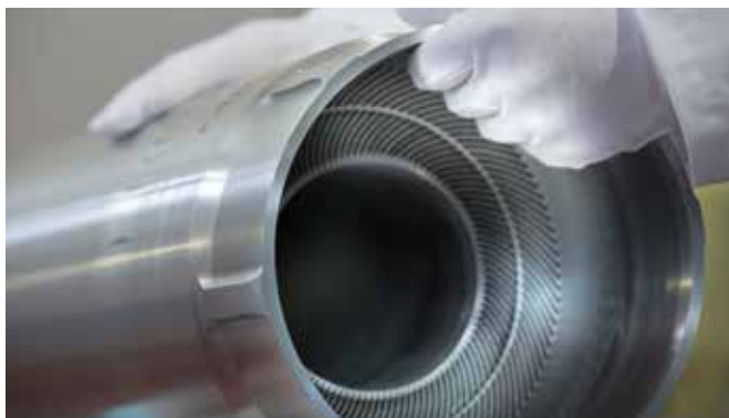
Élément combustible de recherche
