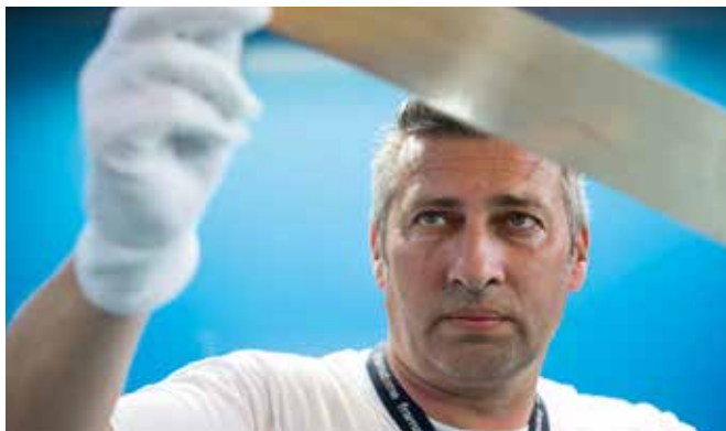
Contrôle visuel d'une plaque combustible
