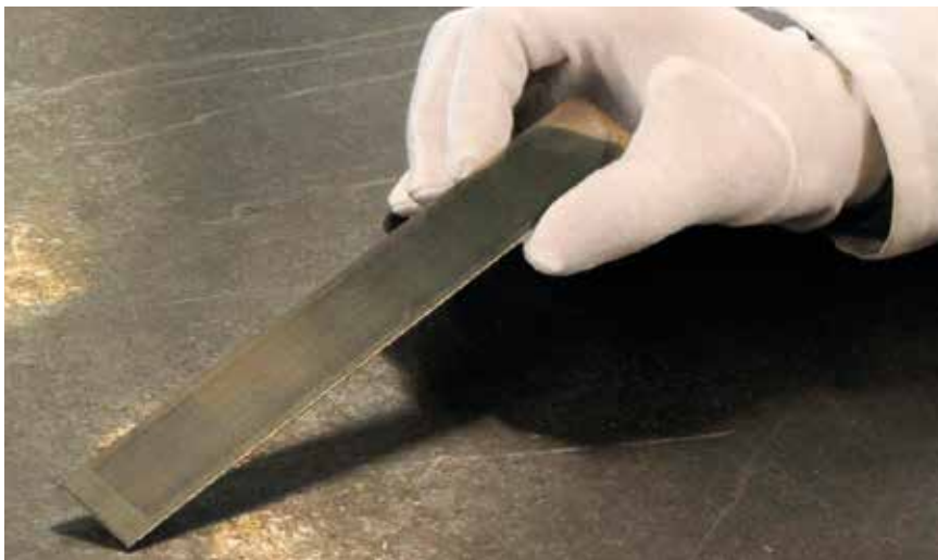
Contrôle visuel d'une plaque combustible
