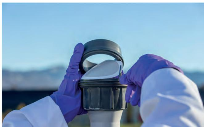
Relevé de filtre sur une des stations de prélèvement atmosphérique
