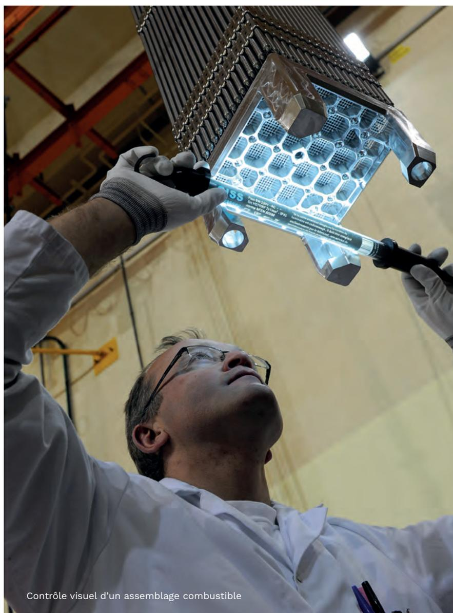
Contrôle visuel d'un assemblage combustible
