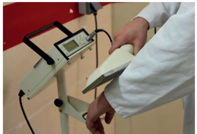
Contrôle de radioprotection en sortie d'atelier
