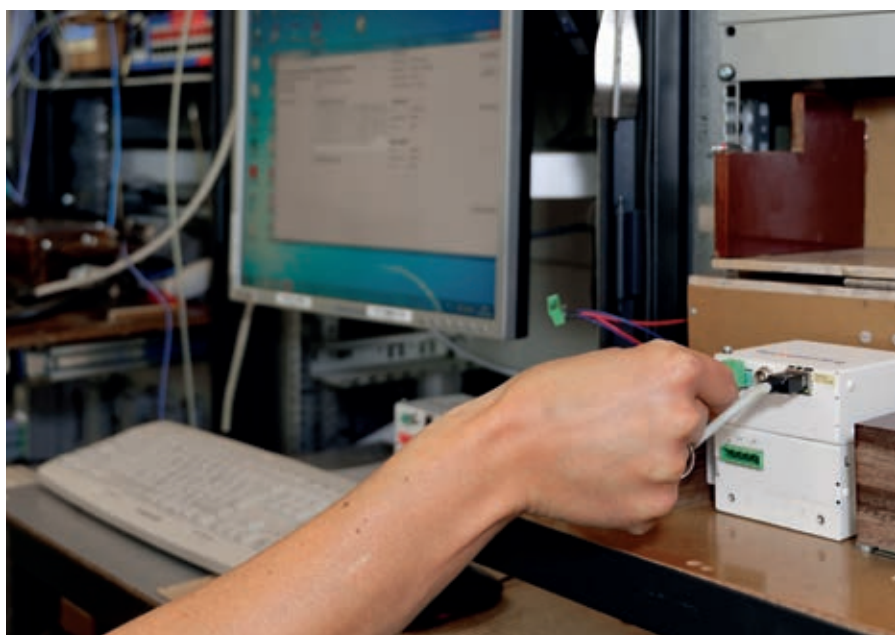
Abb. 35 SIPLUG-Modul im Testaufbau
