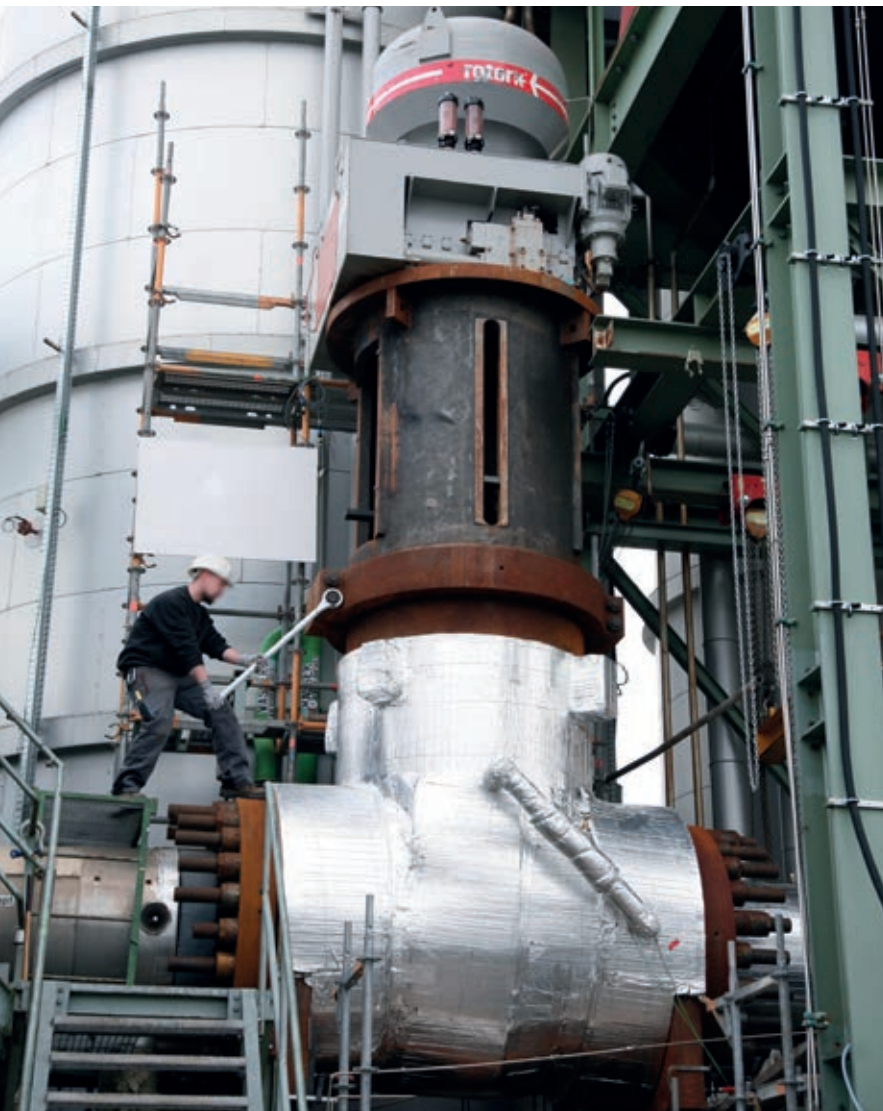
Abb. 10 Großarmatur im Test-Setup im GAP
